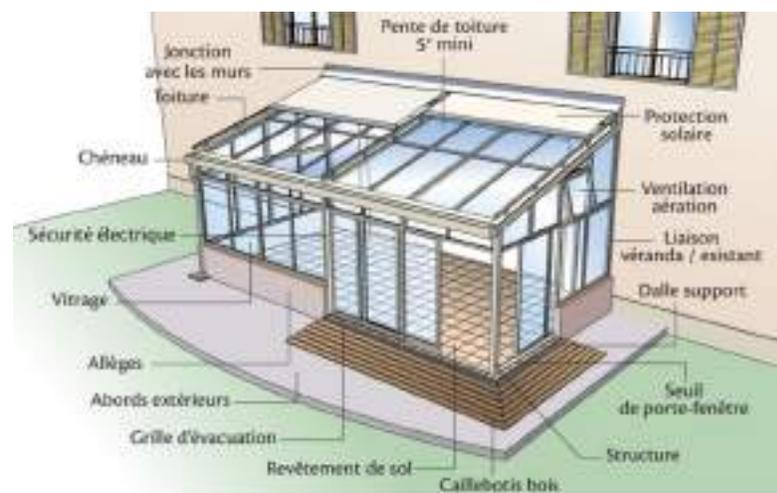
Figure 2 : Terminologie et détails d'une véranda
