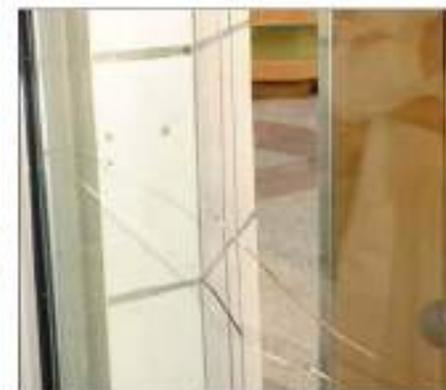
Gradient thermique de moyenne amplitude. Fissure diffuse
