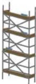
Échafaudage + habilitation au montage + contrôle par le chef
