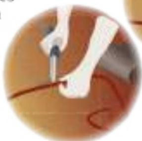
4. Araser le cordon de soudure par un pré-arasage à chaud puis une fois le cordon froid
