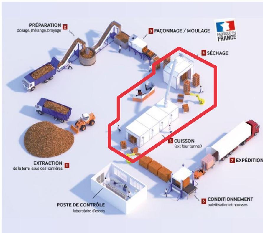
Le potentiel de décarbonation se situe essentiellement au niveau des étapes de séchage et de cuisson
